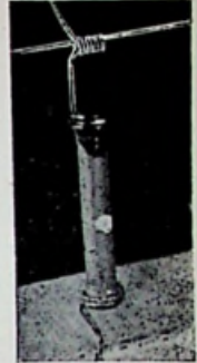
De mooiste soldeerverbinding wordt gemaakt met een soldeerveertje
